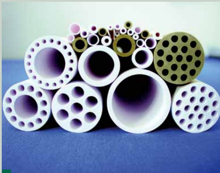
Makrofilter benötigen Nanomembranen: Nanoporöse Keramiken auf Rohrgeometrien zur industriellen Wasserreinigung und Lösemittelaufbereitung. Foto: F-IKTS-ARCHIV
